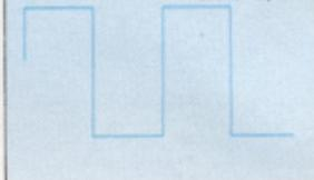
Distorção do amplificador transistorizado comum.
