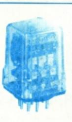
Com 1, 2 ou 3 contatos reversíveis, carga máxima 10 A, com opções até 15 A.
