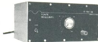
Especificações técnicas: saída, 0 a 15 V ajuste contínuo; limitação de corrente a 2 A; proteção contra curto-circuito; regulação, 0,1% entre 0 e 1A de carga; ripple e ruído na saída, 100 mV.
